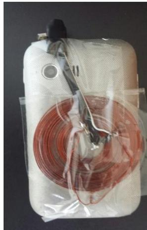
Figura 11 – Aparelho celular conectado a bobina secundária
