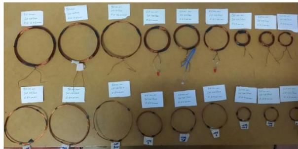
Figura 7 – Vários indutores (bobinas) de diversos tamanhos e diâmetros
