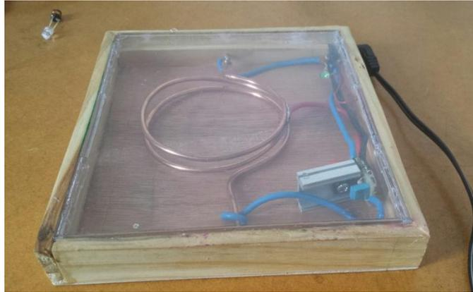
Figura 10 – Plataforma do protótipo com a bobina primária
