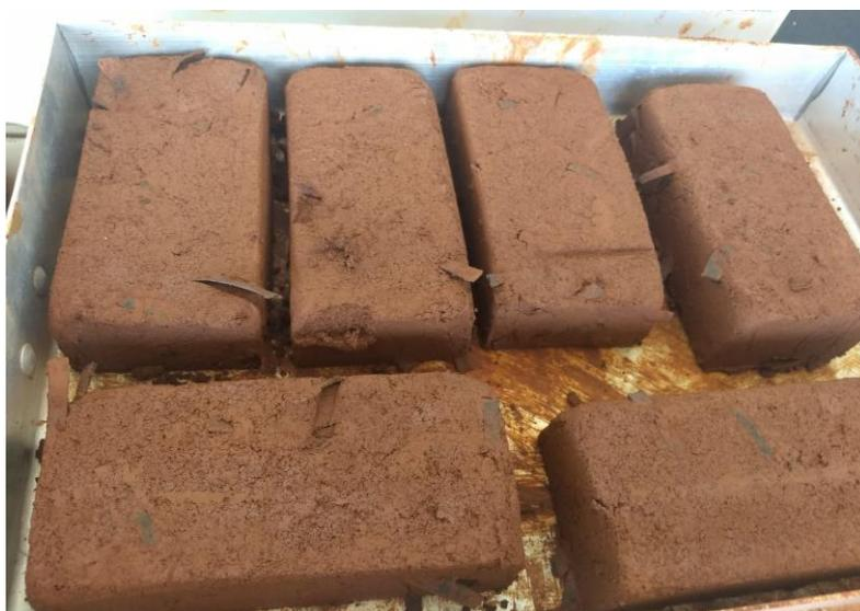
Figura 1. Cura dos tijolos com adição de borracha.
