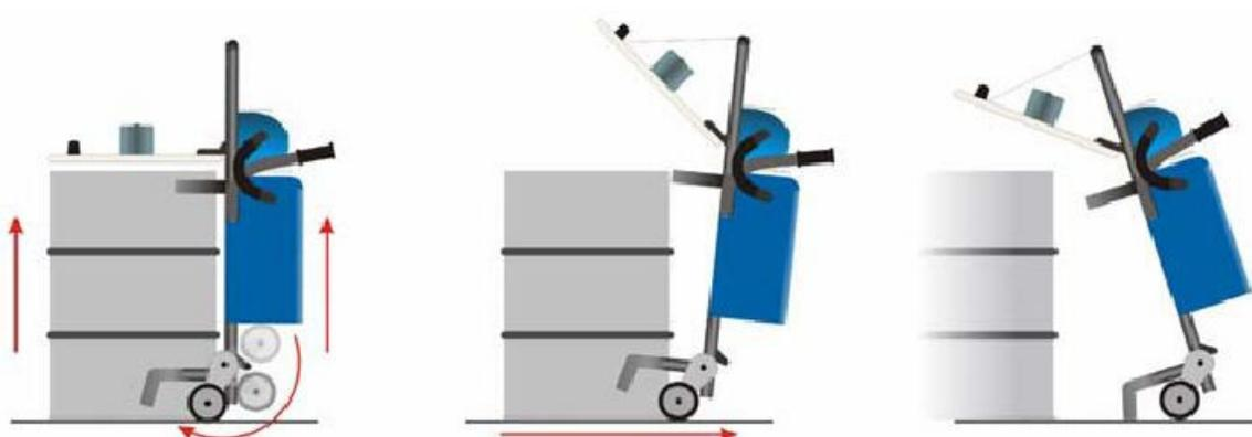
Figura 03 – Ilustração do mecanismo de acoplamento do equipamento ao tambor metálico.
