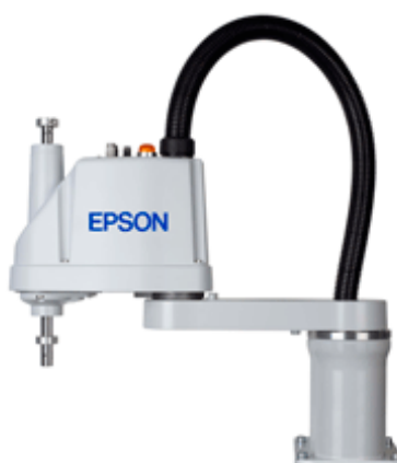
Figura 2: Robô SCARA EPSON Fonte: Manual de Operação Robô Scara Epson LS 3
