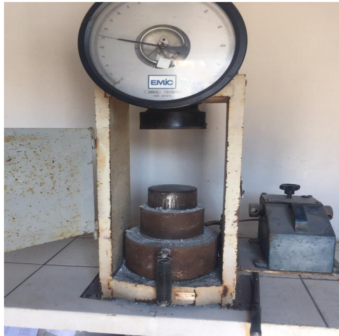
FIGURA 3 – Aparelho para realização de teste de Compressão e Tração Diametral
