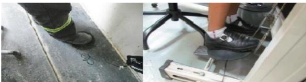
Figura 6 – Posicionamento acelerômetro para vibração de corpo inteiro.
