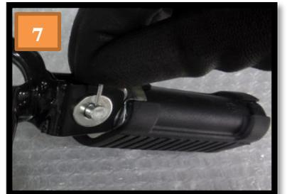
Figura 18 – Montar cupilha.
