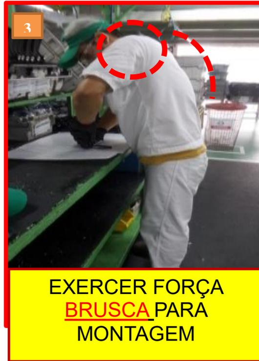
Figura 16 – Montar o pino até o seu limite.
