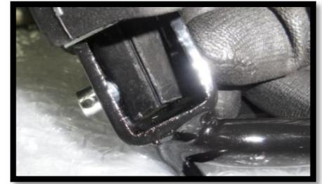
Figura 26 – Montar o pino ate o seu limite.
