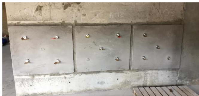
Figura 14: Pastilhas metálicas coladas nos cortes de corpo de prova Fonte: Autores, 2018.
