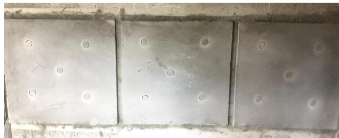
Figura 13: Painéis com seus respectivos cortes para colagem das pastilhas metálicas Fonte: Autores, 2018.
