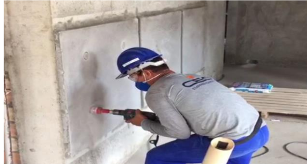
Figura 12: Corte à seco dos CP's utilizando furadeira e serra copo de 50mm Fonte: Autores, 2018.
