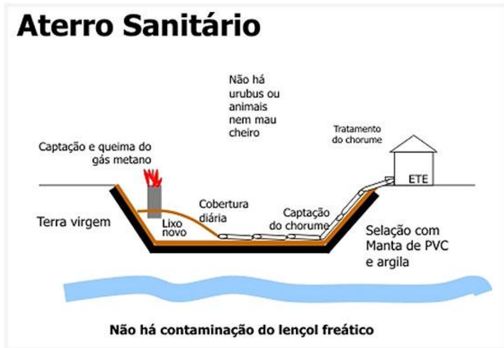
Figura 6 – Funcionamento de um aterro sanitário. Fonte: Meio Ambiente Online (2012).
