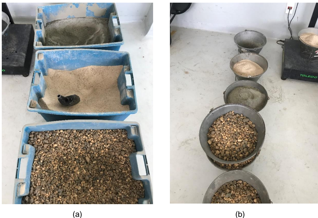
Figura 10: (a) Armazenamento dos materiais no laboratório da concreteira, (b) Separação e pesagem dos materiais para iniciação do traço. Fonte: Autoria Própria, 2018.
