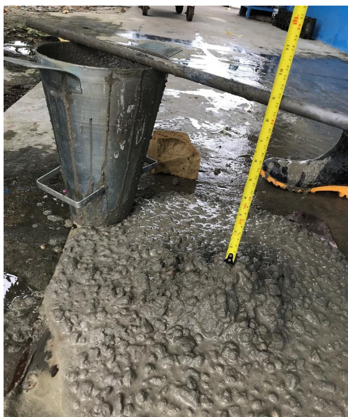
Figura 54: Ensaio de abatimento do concreto. Fonte: Autoria Própria, 2018.
