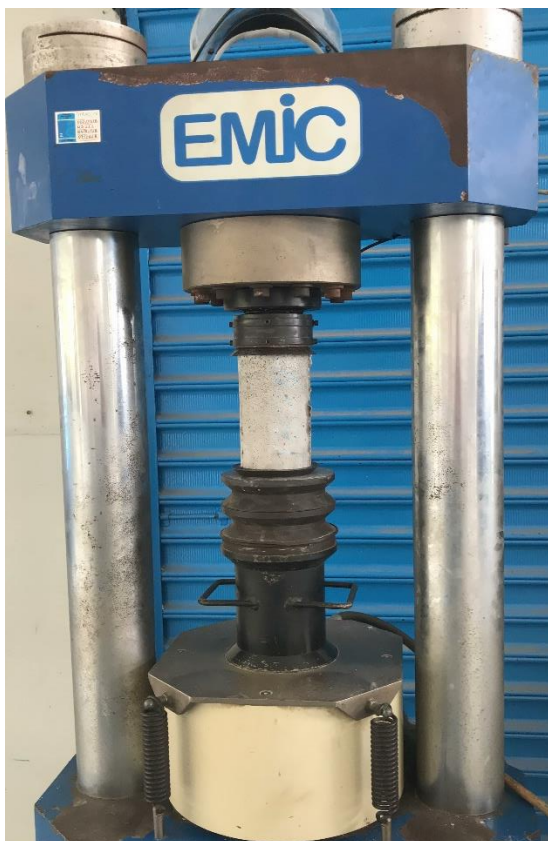
Figura 16: Prensa hidráulica utilizada para rompimento de corpo de prova. Fonte: Aatoria Própria, 2018.
