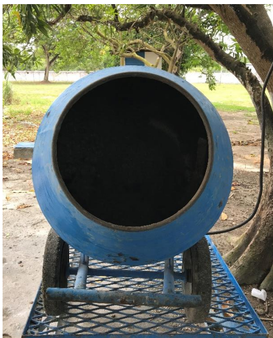
Figura 42: Betoneira de experimentos da concreteira em que se rodou o concreto. Fonte: Autoria Própria, 2018.
