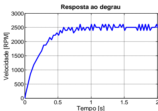
Figura 11: Resposta da montagem prática ao degrau.
