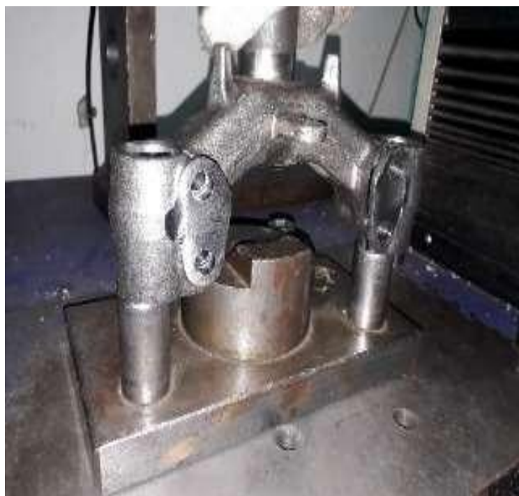
Figura 8 – Imagem da posição da peça para teste de compressão e tração.
