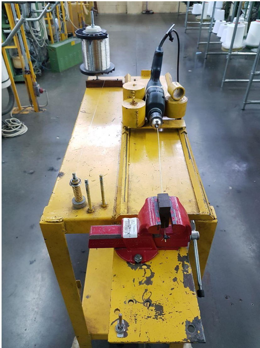
Figura 11 - Protótipo utilizado na fabricação de molas
