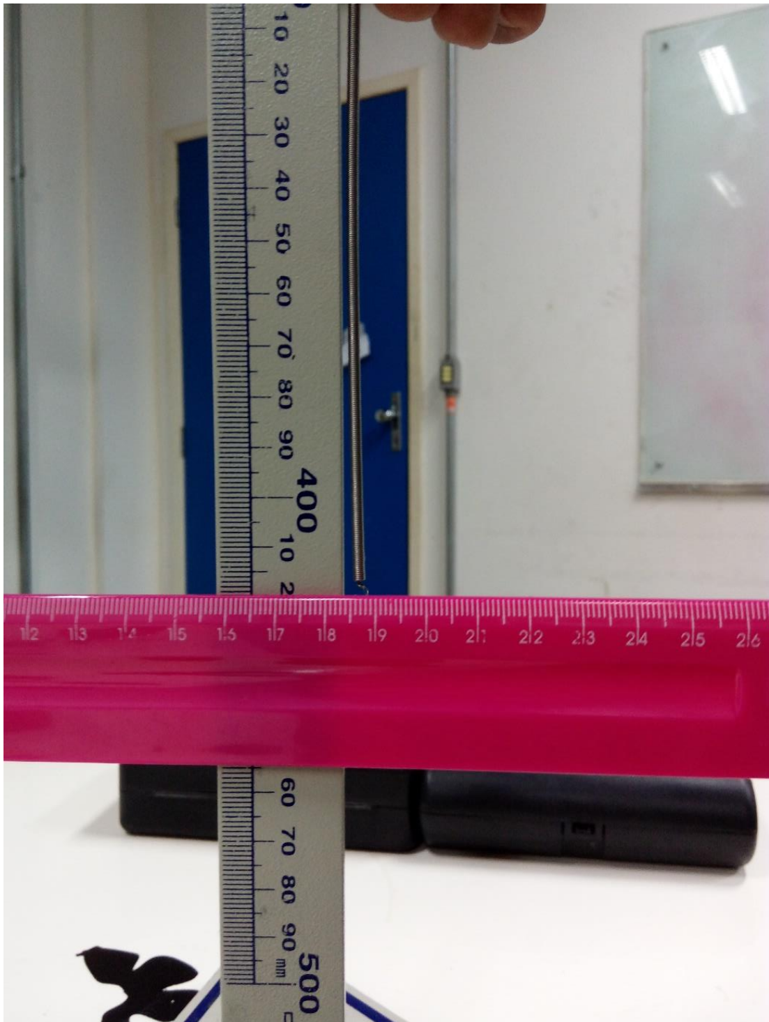
Figura 14 - Marcação do comprimento da mola em seu estado inicial, sem sofrer alongamento.
