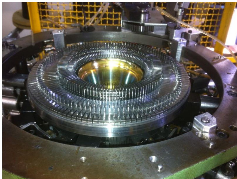
Figura 9- Coroa externa totalmente preenchida com as placas de platina e conjunto de agulhas
