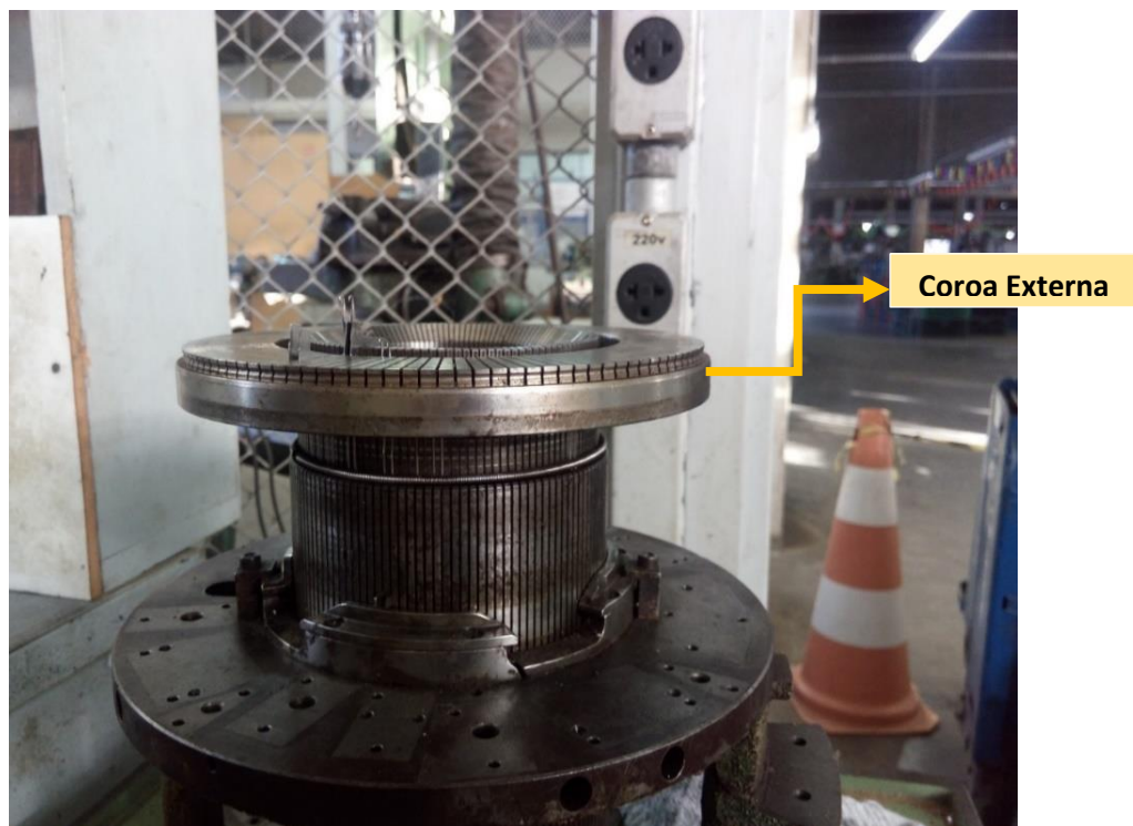
Figura 7 - Fixação da coroa externa
