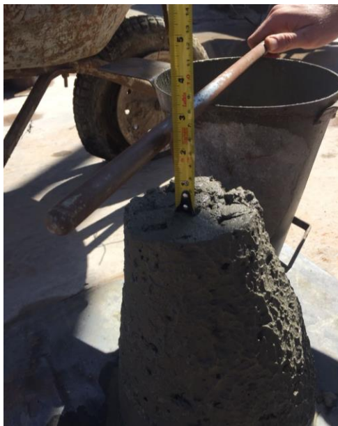
Figura 1 – Determinação da consistência do concreto
