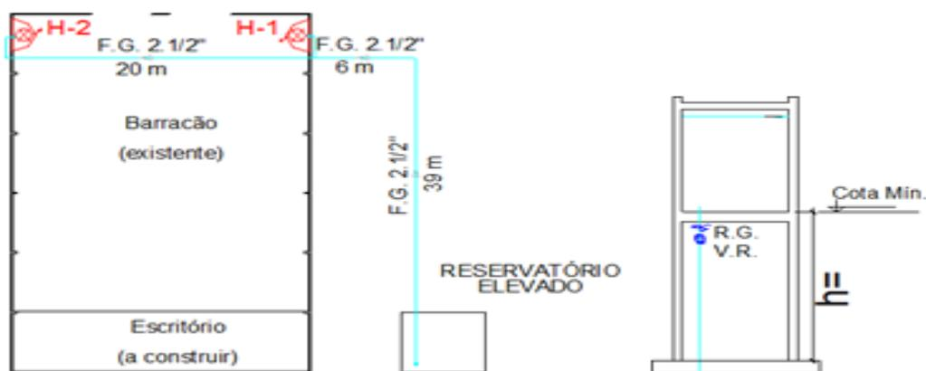
Figura 8 – Planta baixa , Corte Reservatório elevado.
