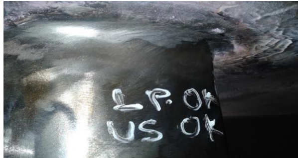
Figura 9: Ensaio de LP e UT aprovados.
