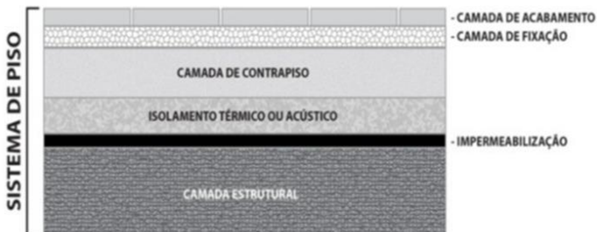
Figura 7 – Sistema de pisos: camadas.
