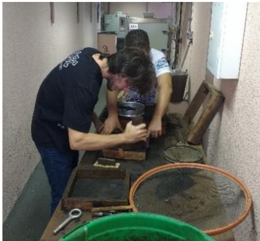
Figura 2 - Compactação da areia sem peneirar.
