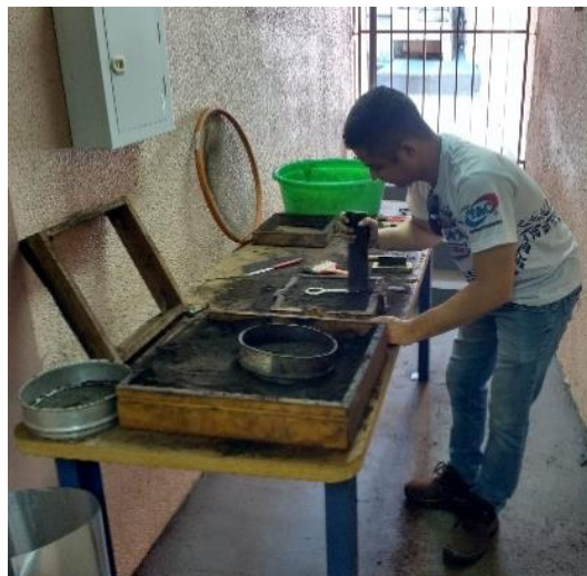
Figura 4 – Compactação da areia peneirada.
