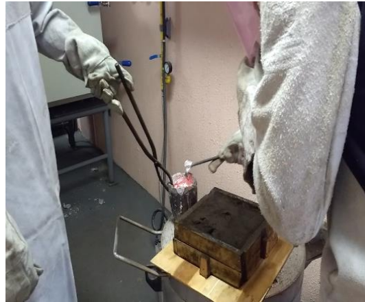
Figura 12 - Retirada da escória.
