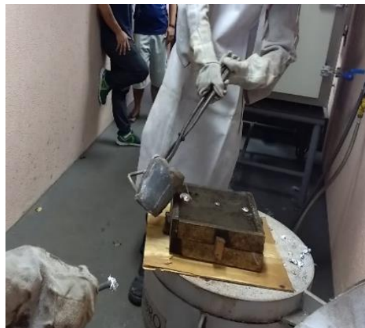
Figura 13 - Vazamento do alumínio.
