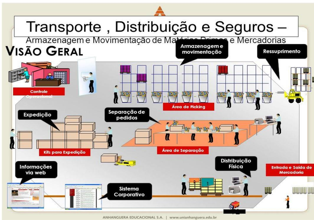
**Figura 2:** Visão geral de um armazém.
