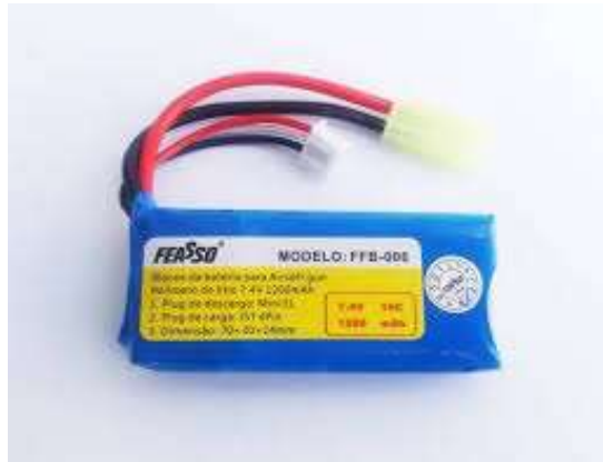
Figura 6-Bateria de Lipo, (LEITE; 2018).
