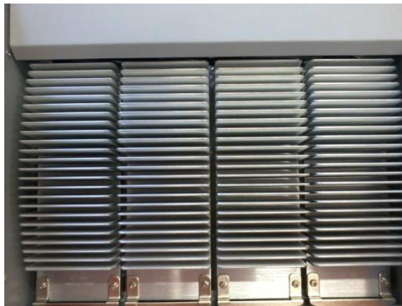
Figura 18 – Dissipador de calor acoplado com cada módulo. Fonte: Anglogold Ashanti, 2012.
