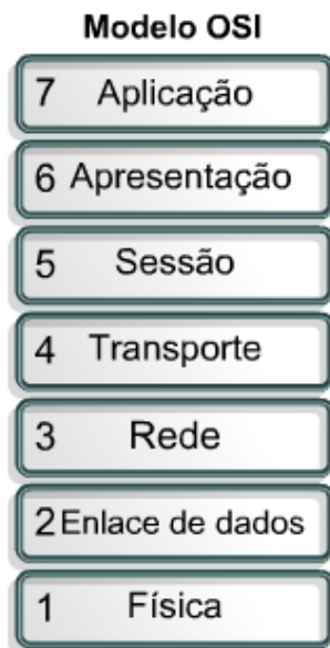
Figura 3 – Modelo OSI de arquitetura de protocolos de rede Extraído de Canovas (2006).
