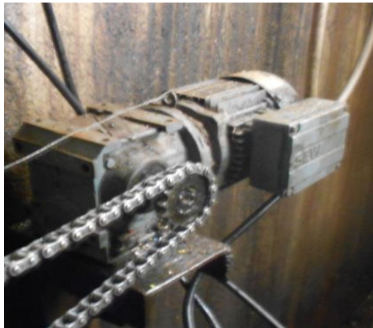
Figura 19: Motor acoplado na caixa de redução
