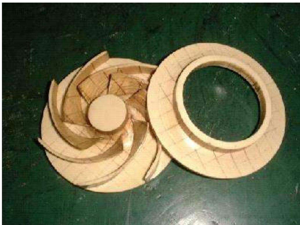
Figura 18 - Objeto conformado por LOM - Fonte: Imanishi, 2015.
