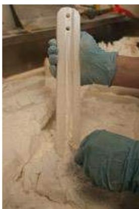
Figura 21 - Produto conformado em SLS - Fonte: UTEXAS, 2015.
