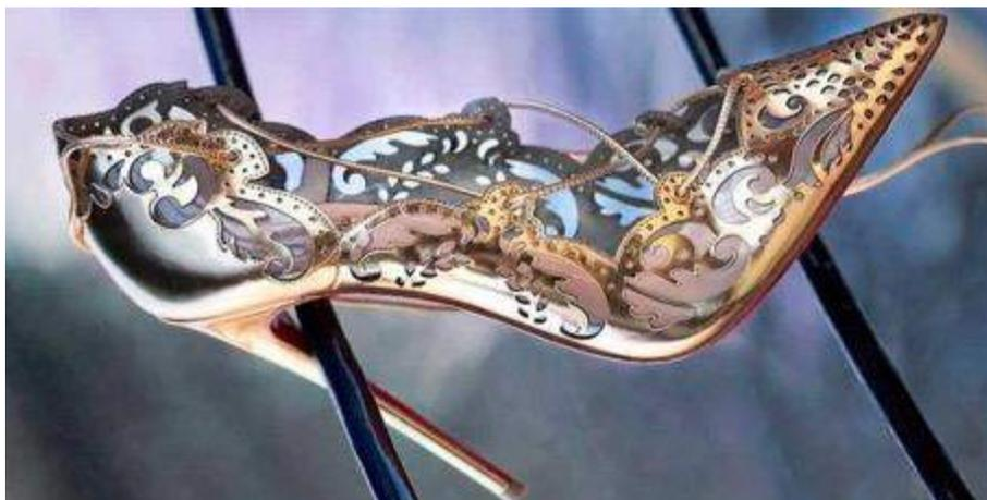
Figura 13 - Corte a laser em couro com aplicação em calçado - Fonte: ExportLaser, 2016.
