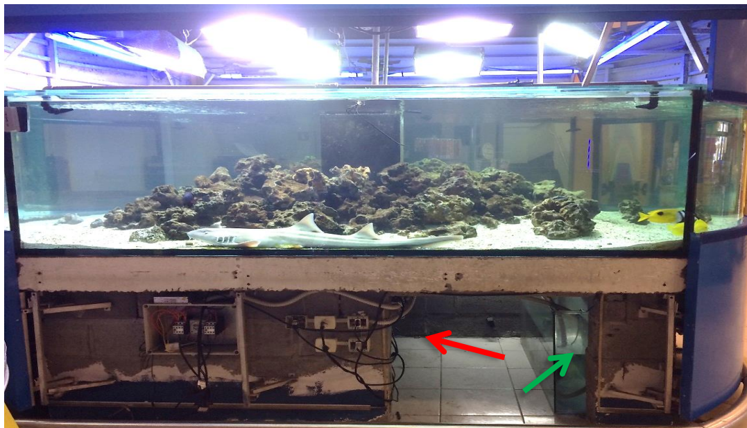
Figura 1. Foto do tanque onde a espécie está acondicionada. Seta verde indica o Sump com água de reposição. Seta vermelha indica o Sump principal com as filtragens. Fonte: Moraes, P.V., (2016).
