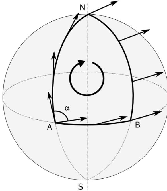
Figura 4: transporte paralelo sobre uma superfície esférica
