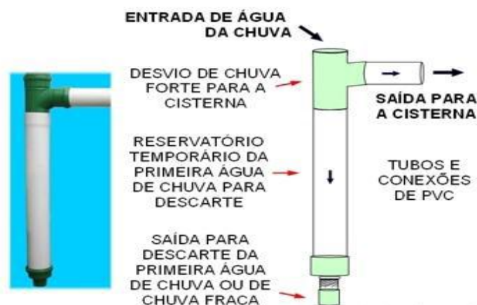
Figura 25: Separador de água (primeira chuva).
