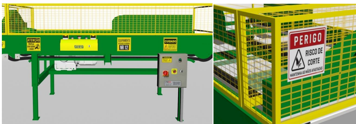
Figura 9.1 e 9.2: Sinalização de alerta conforme sugerido pela NR12.
