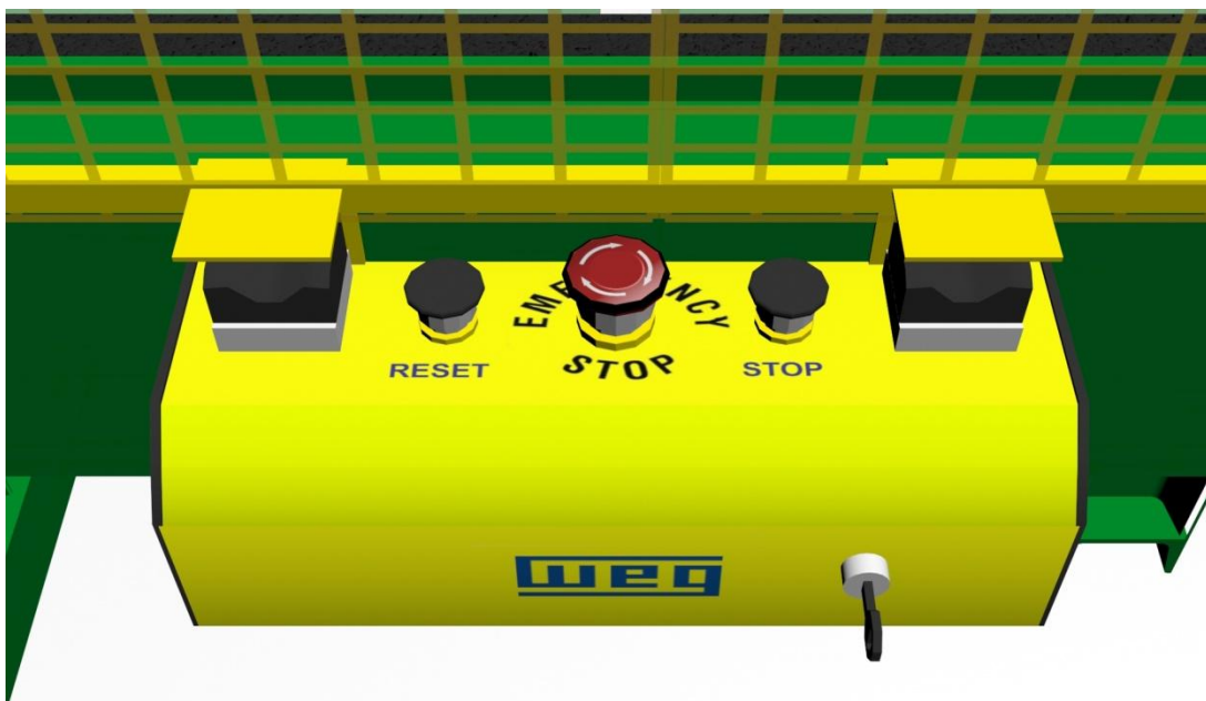
Figura 6: Vista do comando bimanual exigido pela NR12.
