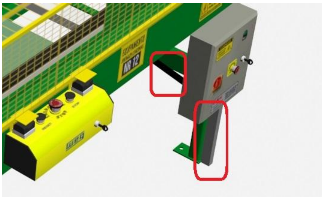
Figura 4: Vista do painel elétrico adequado a NR12.
