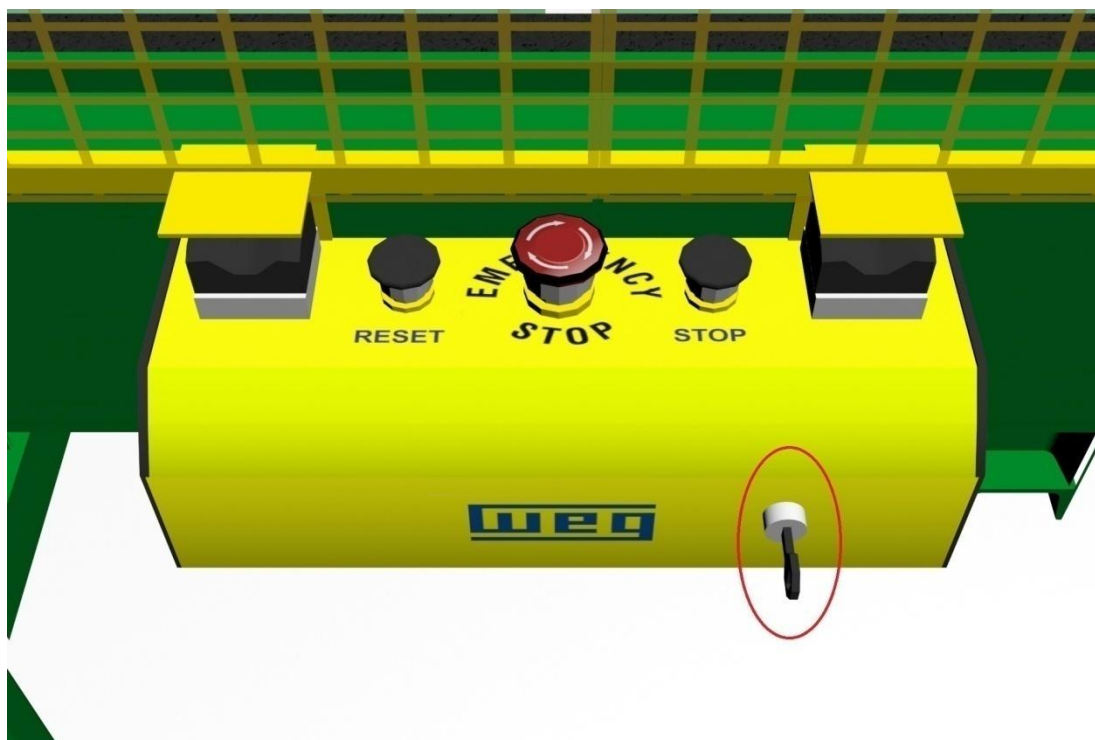
Figura 7: Chave de setup automático ou manutenção conforme a NR12.
