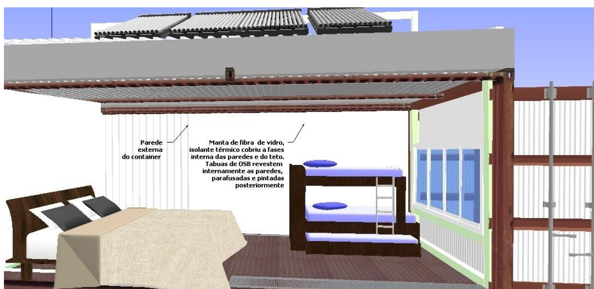
Figura 4- Corte demonstrando a composição das vedações
