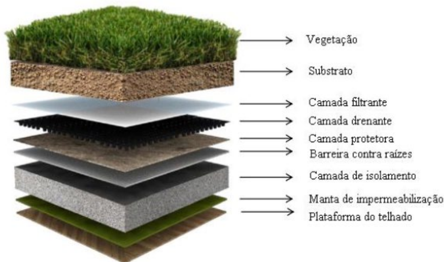
Figura 1: Componente do telhado verde
