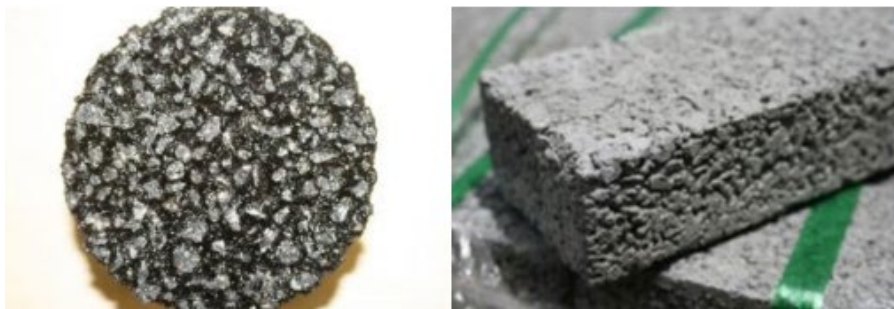
Figura 4: a) asfalto poroso CPA e b) bloco de concreto poroso
