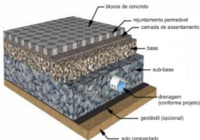
Figura 2: Pavimentação com blocos de concreto permeável com drenagem da água.
