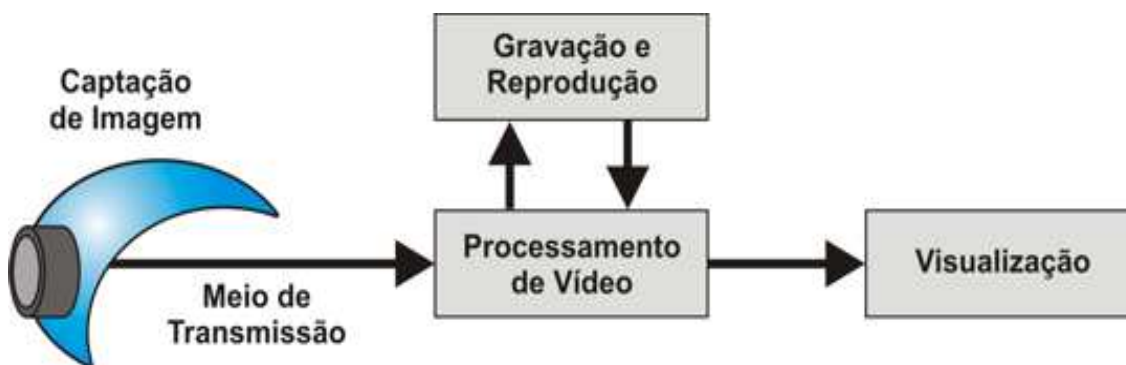
Figura 9 – Diagrama em blocos básico do sistema de CFTV Fonte: Peres, 2006.
