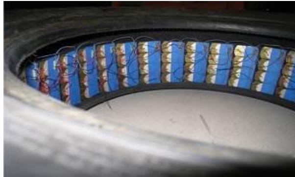
Figura 3- Nanogeradores Piezoelétricos dentro dos Pneus.
