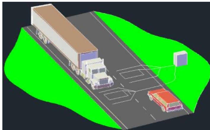
Figura 4: Posicionamento do Sensor Piezoelétrico.
