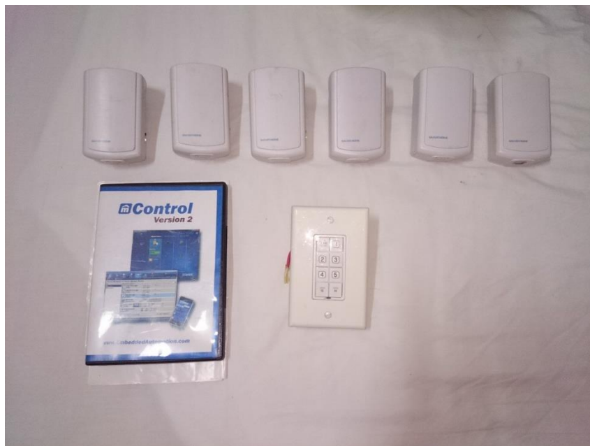
Figura 35 - Conjunto 5 tomadas comandadas por controle único em parede
