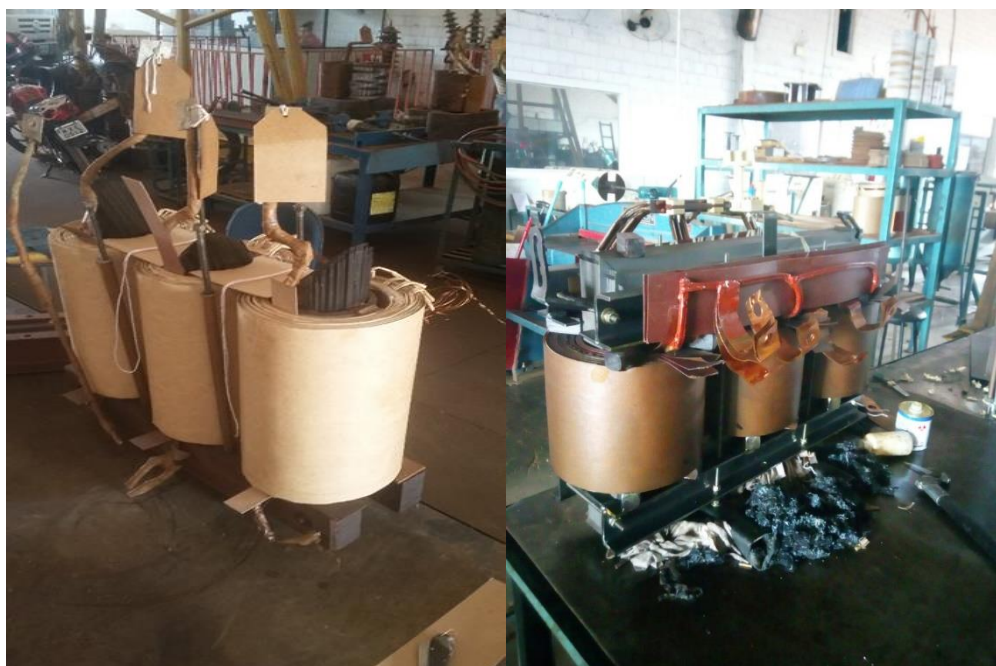
Figura 2: Parte ativa do Trafo de potência
