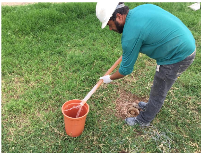
Figura 5 – Amostrador descartável de água subterrânea (Bailer)
