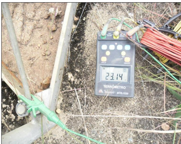
Foto 5 – Aferição da resistividade da torre de 10 metros
