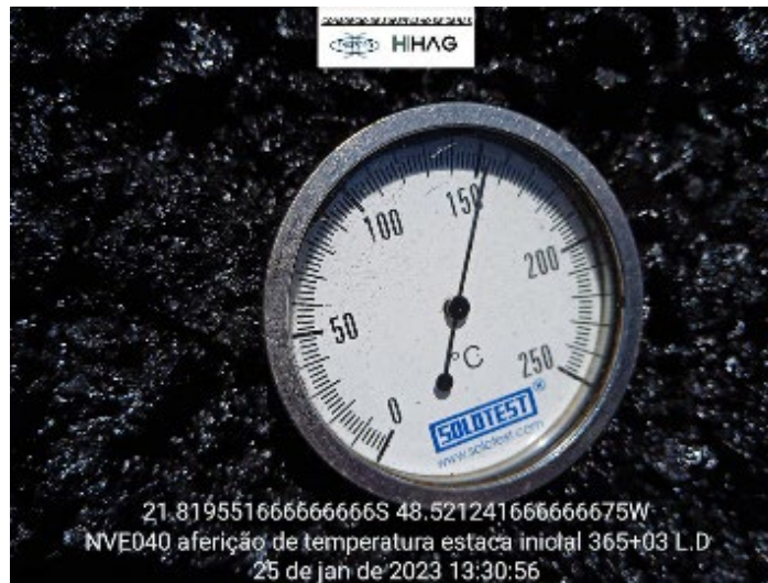
Figura 4 – Verificação da temperatura
