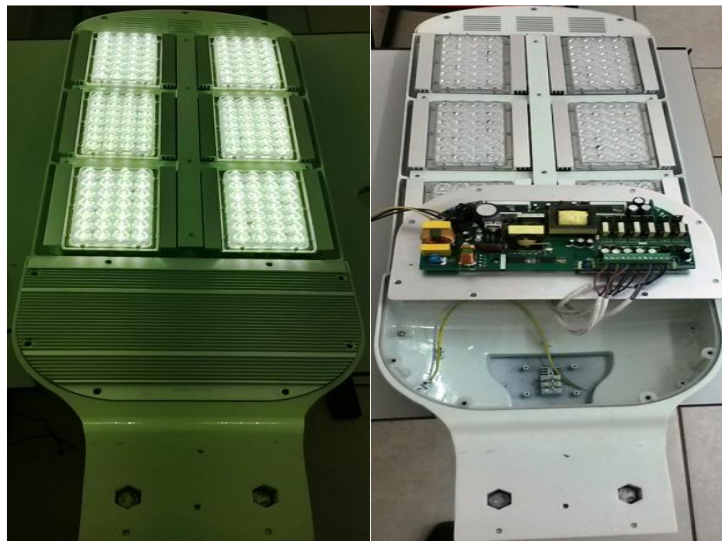
Figura 1 - Luminária LED BBE LU-6 e fonte de alimentação.
