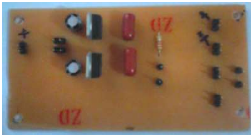
Figura 26: Circuito impresso de alimentação.
