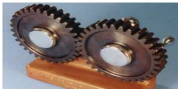
Figura 21: Engrenagem cilíndrica de dentes retos trabalhando de forma conjugada.
