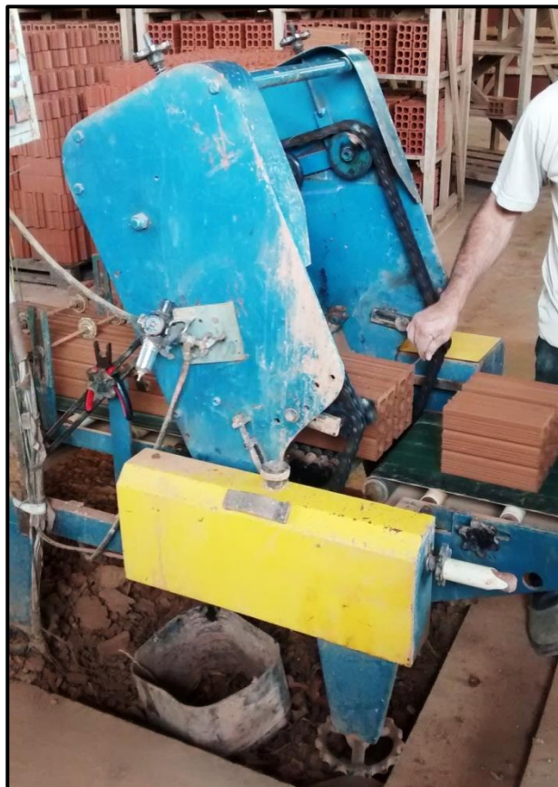
FIGURA 29 – Empregado utilizando os dedos para limpeza da prensa. Fonte: Autor (2016).
