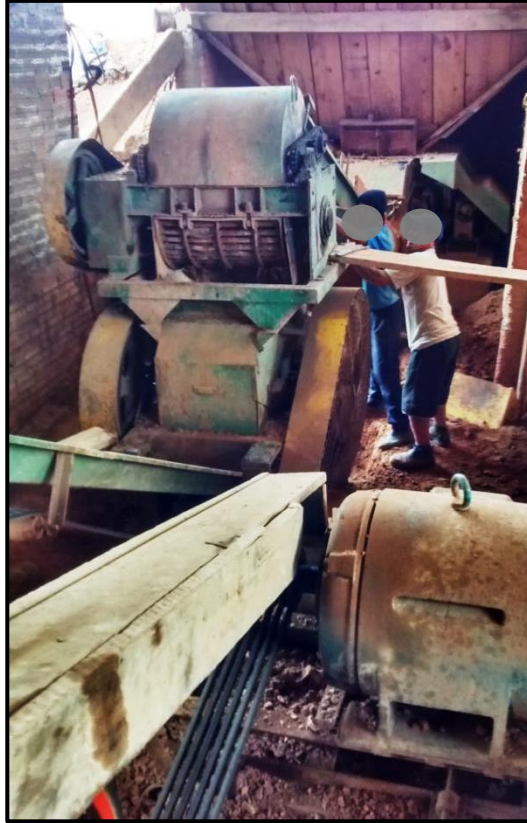
FIGURA 39 – Funcionários realizando limpeza na maromba. Fonte: Autor (2016).
