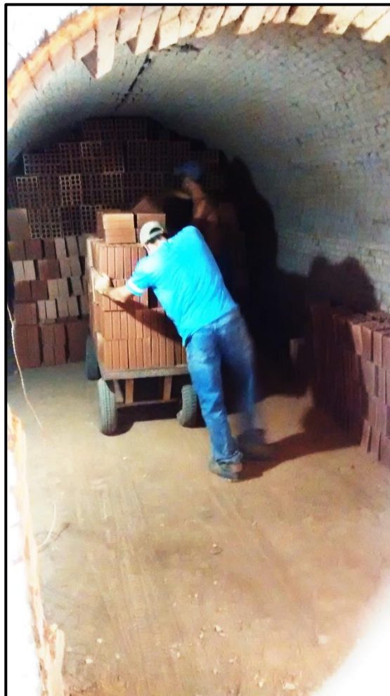
FIGURA 34 – Tijolos sendo depositados nos fornos para secagem a 800 °C. Fonte: Autor (2016).
