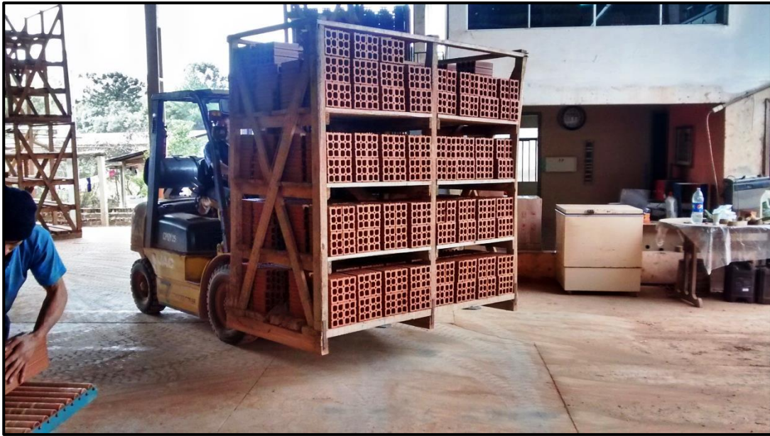
FIGURA 31 – Prateleiras com tijolos verdes sendo encaminhadas para secagem natural.
