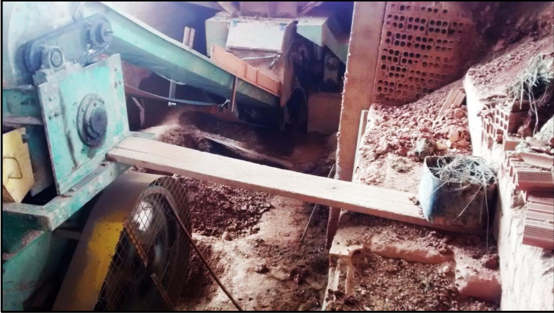
FIGURA 26 – Passarela de madeira improvisada entre o depósito de argila até a maromba.
