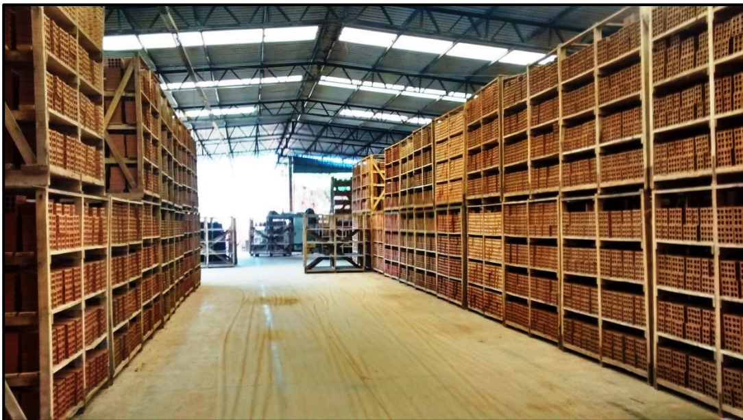
FIGURA 32 – Conjunto de prateleiras com tijolos verdes aguardando a secagem natural.
