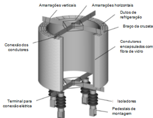
Figura 02. Reator a seco com núcleo de ar e
