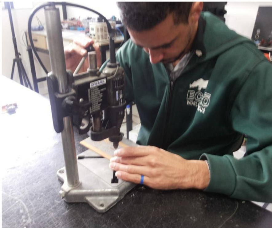
Figura 33: Processo de perfuração da placa do conversor push-pull
