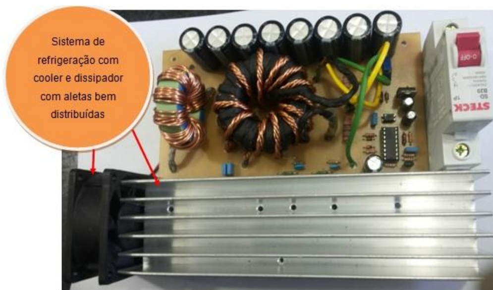
Figura 36: Sistema de refrigeração do protótipo.
