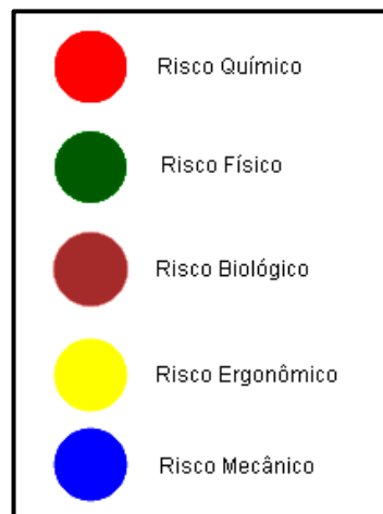
FIGURA 14 – Indicação de cores para cada risco observado. Fonte: JATOBA et al.,(2011).
