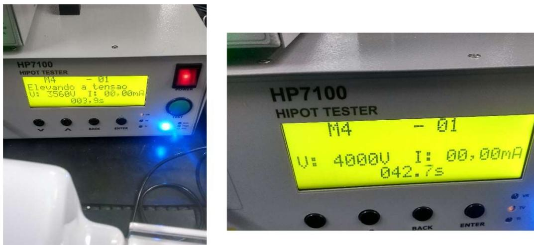
Figura 11 – Ensaio sendo aplicado
