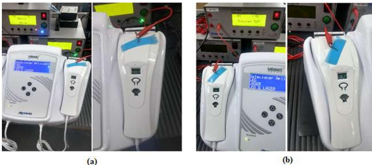
Figura 6 – Localização dos pontos de prova para aplicação do teste nas canetas (a) e (b) do equipamento
