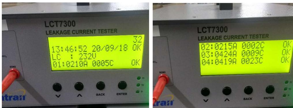
Figura 12 – Resultados corrente de fuga para o terra
