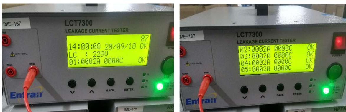
Figura 14 – Resultados corrente de fuga através do gabinete
