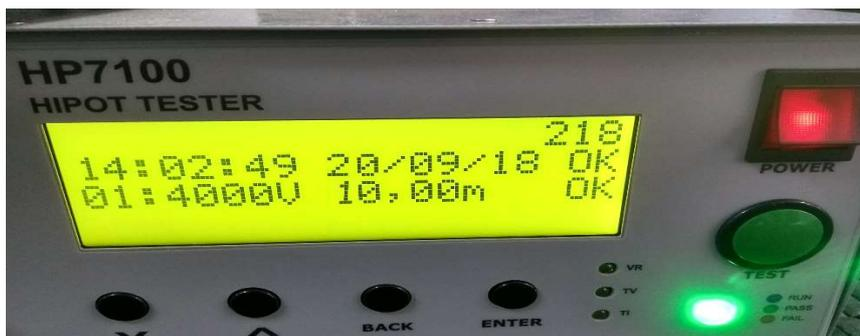
Figura 15 – Resultados ensaio de rigidez dielétrica
