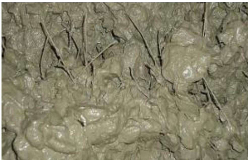
Figura 17 – Mistura de concreto reforçado com fibras de aço
