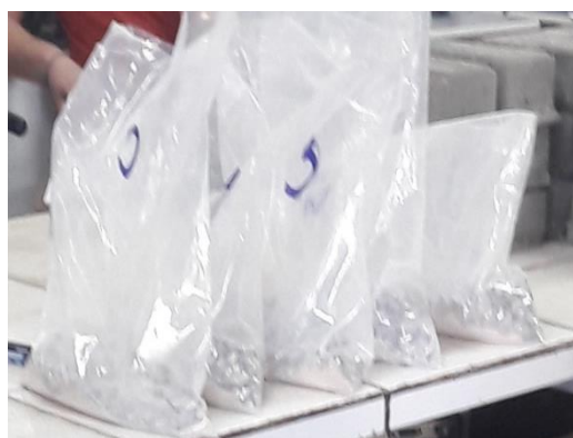
Figura 16. Agregados homogeneizados Fonte: Autor, 2017.
