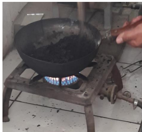
Figura 18. Mistura sendo homogeneizada após a adição do CAP. Fonte: Autor, 2017.
