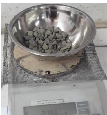
Figura 15. Pesagem dos agregados Fonte: Autor, 2017.
