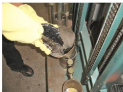
(c) Colocação da mistura no molde
