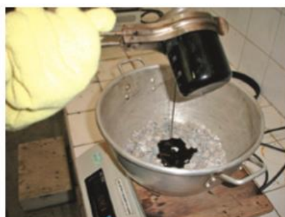
(a) Adição de asfalto aos agregados
