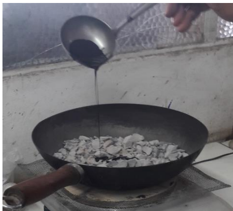
Figura 17. Ligante sendo adicionado aos agregados. Fonte: Autor, 2017.
