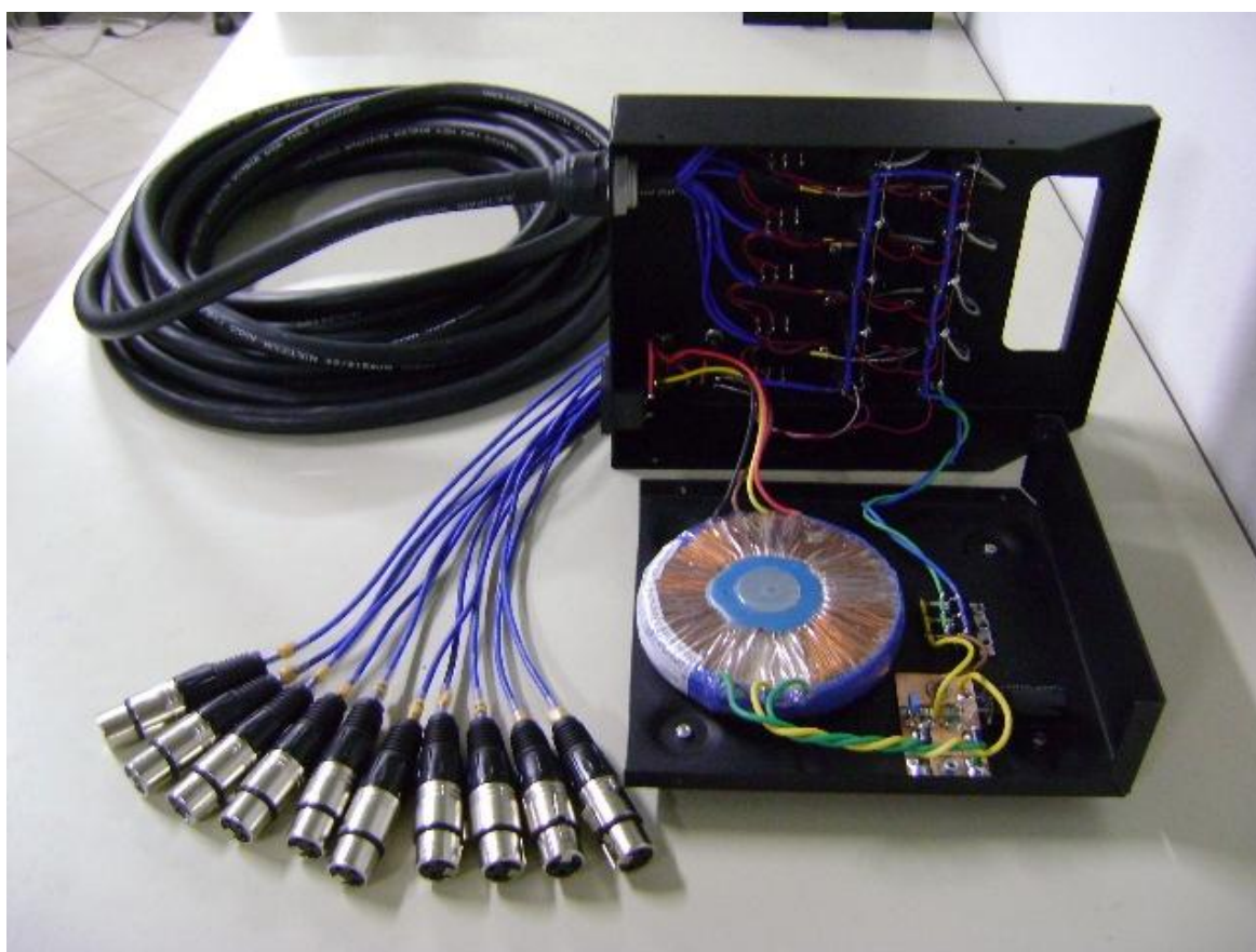
Figura 28: Multicabo de 10 vias conectado à Fonte de Alimentação
