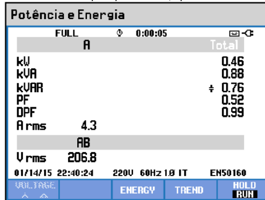
Figura 12. Indicação da característica de potência reativa capacitiva injetada no sistema elétrico da concessionária pelo split inverter (captura de tela do Fluke 434).
