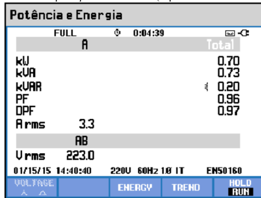
Figura 7. Característica de potência reativa indutiva absorvida do sistema elétrico pelo split convencional (captura de tela do Fluke 434).
