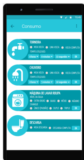
Figura 3 – Tela para a inserção dos dados do consumo per capita do usuário
