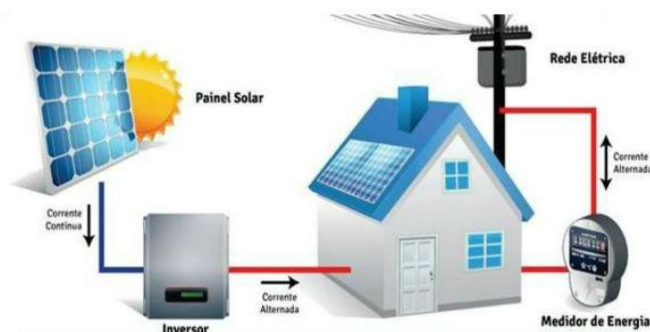
Figura 1. Funcionamento da instalação Residencial do sistema Fotovoltaico
